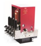
Der Hydraulic Service Manifold von Moog (HSM) liefert ein-/ausschaltbaren hydraulischen Druck mit regelbarem Übergang von drucklos zu hohem Druck. Die empfindlichen Servoventile werden durch Filter geschützt, und Druckspei-cher sorgen bedarfsgerecht für eine sofortige Strömung oder Druckdämpfung. Es sind mehrere Strömungsraten mit 1 bis 4 Stationsoptionen verfügbar.
