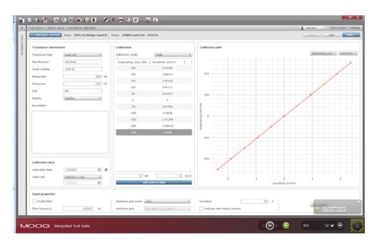
Dieser Bereich ermöglicht dem Benutzer die Konvertierung von Sensorsignalen (Spannungen) in die gewünschte technische Notation. Ein Kalibrierungs-Assistent führt den Benutzer durch den einfachen Prozess. Die Sensorempfindlichkeit kann direkt eingegeben oder von bis zu 99 Punkten für eine präzise Linearität berechnet werden.
