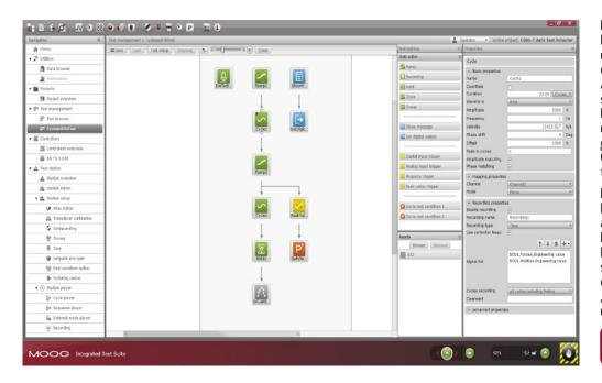
Der Test Builder ermöglicht dem Benutzer die schnelle Erstellung und/oder Bearbeitung von Testdefinitionen. Tests bestehen aus Anweisungen, Aktionen, Auslösern oder Ressourcen wie Drive-Dateien. Diese Anweisungen umfassen Elemente wie Übergang, Aufzeichnung, Zyklus oder Gruppierung für die Verschachtelung von Anweisungen.
