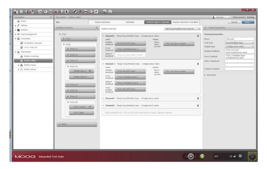
Dies ist der zentrale Ort für die Konfiguration der Hardware und Software der Station. Der Benutzer fügt spezifische Hardware-I/O hinzu, erstellt logische Kanäle und gewünschte Regelkreise und kann Pseudokanäle für Berechnungen hinzufügen.
