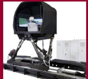
7-DOF-System mit seitlicher Schiene
