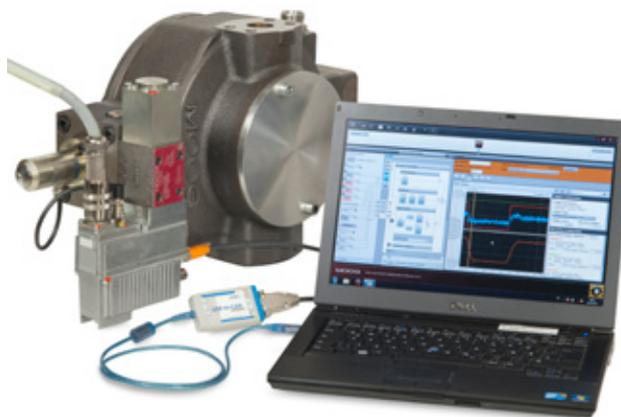
Die Moog Ventil- und Pumpen-Konfigurationssoftware ist über eine IXXAT-Schnittstellenkarte und einem CAN-Kabel mit der RKP-D verbunden.
