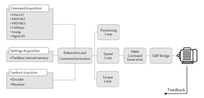
Figure 2: DS2020 System Theory of Operation Flow Chart
