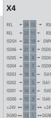
Tabelle 3.9 Spezifikation der Steueranschlüsse X4
